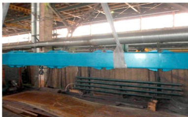
ИЗГОТОВЛЕНИЕ ШТАНГИ КВАДРАТНОГО СЕЧЕНИЯ ДЛЯ ЯПОНСКОЙ БУРОВОЙ УСТАНОВКИ КАТО
