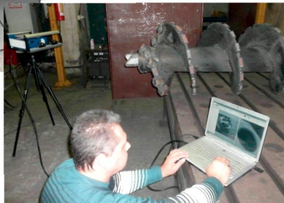
КОНТРОЛЬ КАЧЕСТВА ИЗДЕЛИЙ С ПОМОЩЬЮ 3D СКАНЕРА
