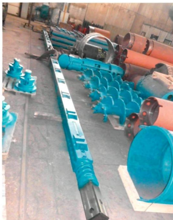
ИЗГОТОВЛЕНИЕ ШТАНГИ КВАДРАТНОГО СЕЧЕНИЯ ДЛЯ ЯПОНСКОЙ БУРОВОЙ УСТАНОВКИ КАТО
