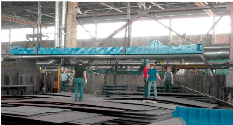
ОТРЕМОНТИРОВАННЫЕ МАТЧЫ БУРОВЫХ УСТАНОВОК BAUER BG-24 И CASAGRANDE
