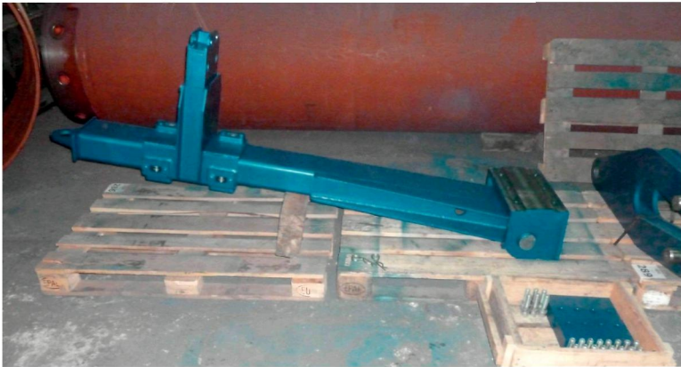
КОМПЛЕКТ НАВЕСНОГО ОБОРУДОВАНИЯ ДЛЯ РАБОТЫ С НЕПРЕРЫВНЫМ ШНЕКОМ ПО ТЕХНОЛОГИИ CFA/SOB НА БУРОВОЙ УСТАНОВКЕ BAUER BG-24
